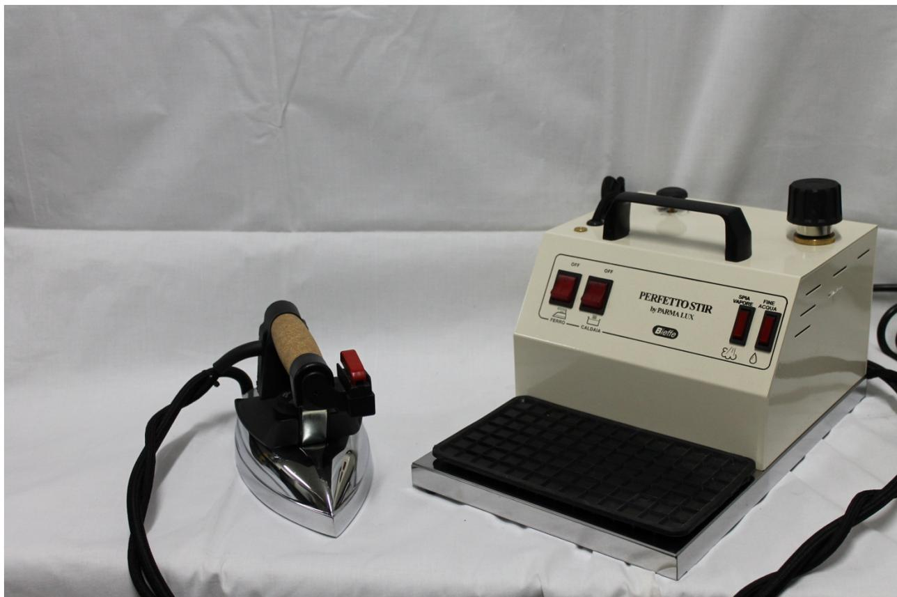
Caldaia Professionale in Rame da 1.5 litri con resistenza esterna, non ha contatto diretto con l'acqua, così da poter utilizzare, o capacità massima, o anche solo 1 bicchiere se ho un solo capo da stirare. Dotata di regolazione del getto di vapore, cicalino per il fine acqua e con ferro BIEFFE Professionale con para vapore e tasto laterale SX.
