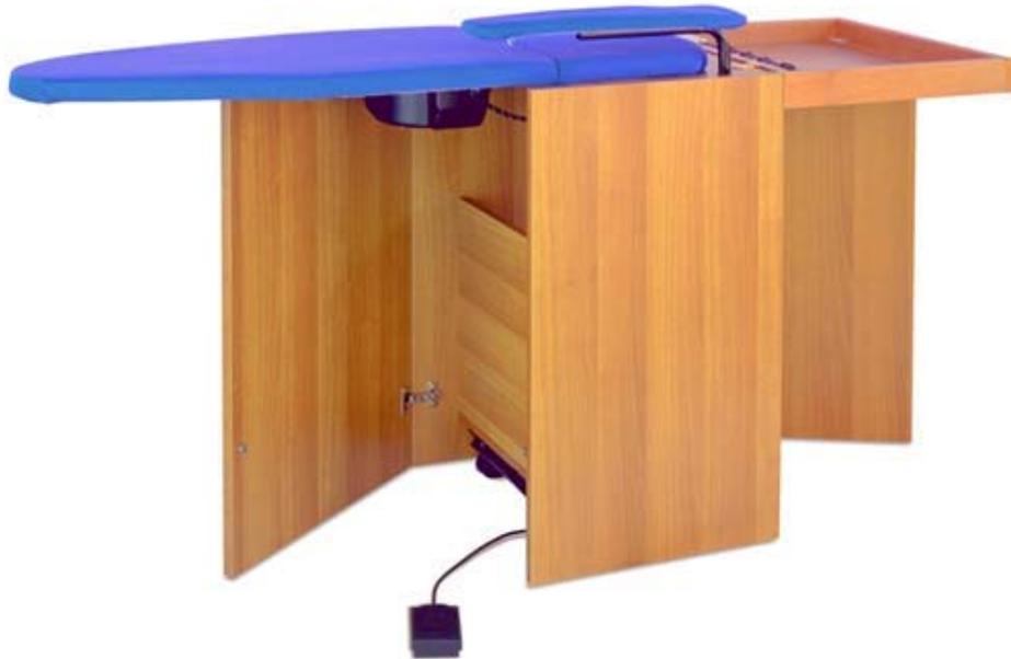
Struttura in legno, piano da stiro termoaspirato in metallo zincato, bracciolo stiramaniche, pedaliera per il comando di aspirazione, ripiano per appoggiare la caldaia, scomparti interni per contenere l'attrezzatura, ruote per lo spostamento del mobiletto bloccabili, ingombro da chiuso cm 24x49x78.
