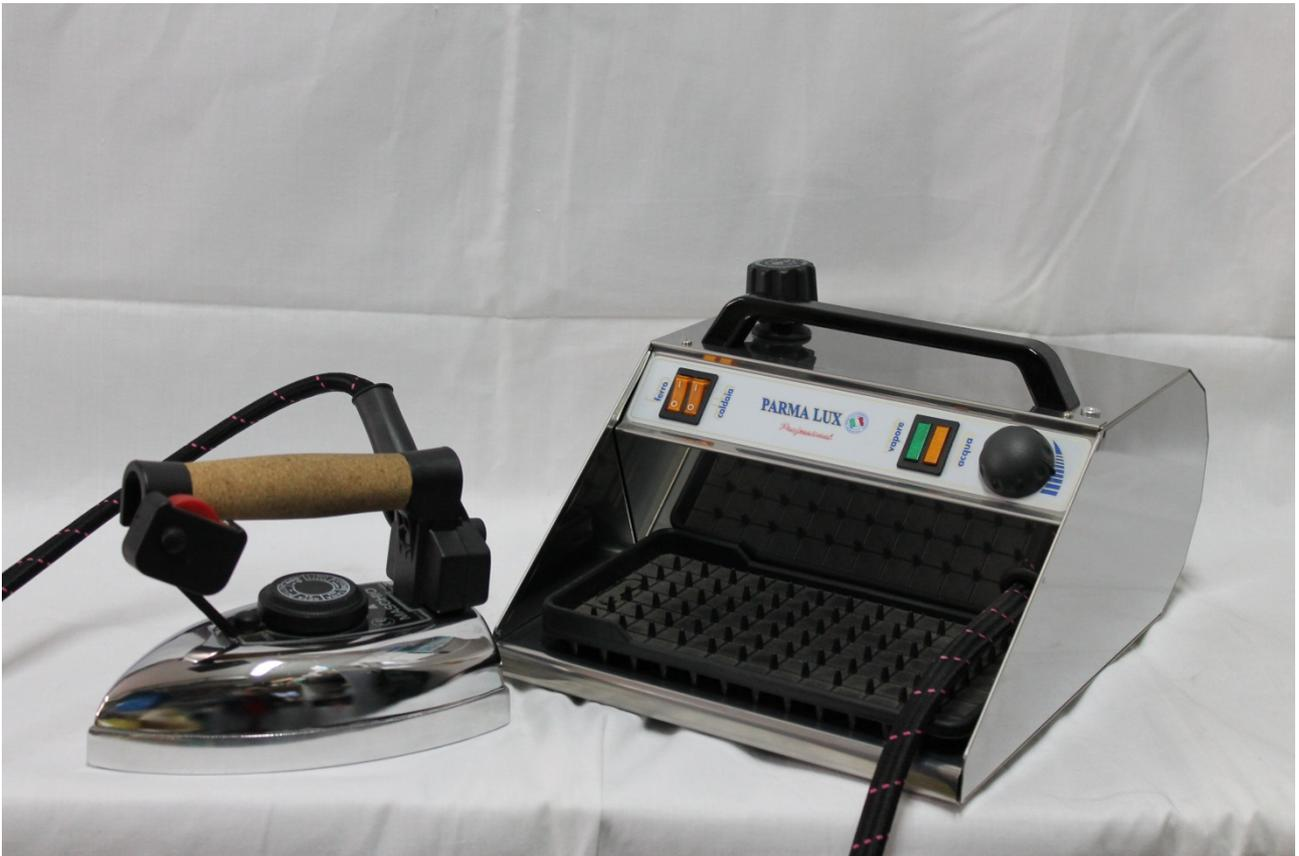
Ferro a caldaia con carrozzeria interamente in acciaio, dotata di maniglia superiore e tendi cavo così da averlo sempre in ordine. Caldaia interna in acciaio INOX 18/10 da 2lt con resistenza esterna così da poter utilizzare sia la capacità massima sia con poca acqua se si ha poco da stirare. Dotata di regolazione del getto di vapore, pressostato per una pressione costante (3,5 bar), e di ferro MASCHIO professionale pesante con resistenza corazzata, manico in sughero e fusibile di sicurezza.
